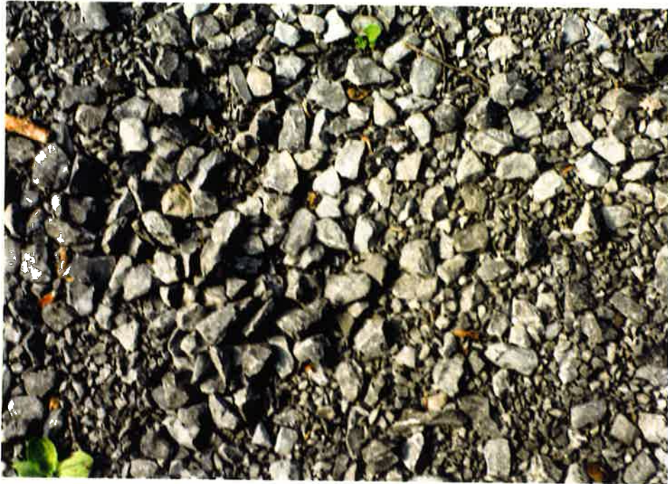
Figure 7-11-3 Pour contrôler l'érosion, il est important de sélectionner un produit qui ne libère pas de calcium et de magnésium. La pierre concassée à base de granit est supérieure à celle à base de calcaire (la photographie ci-dessus montre de la pierre concassée à base de calcaire)
