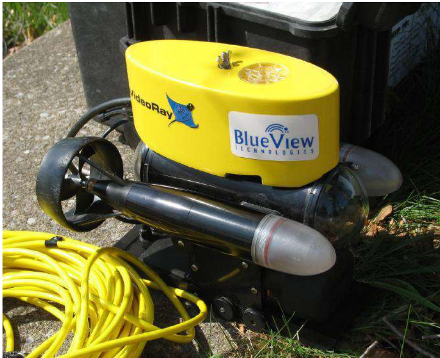
Figure 25: Véhicule submersible opéré à distance pour le ratissage sous-marin
