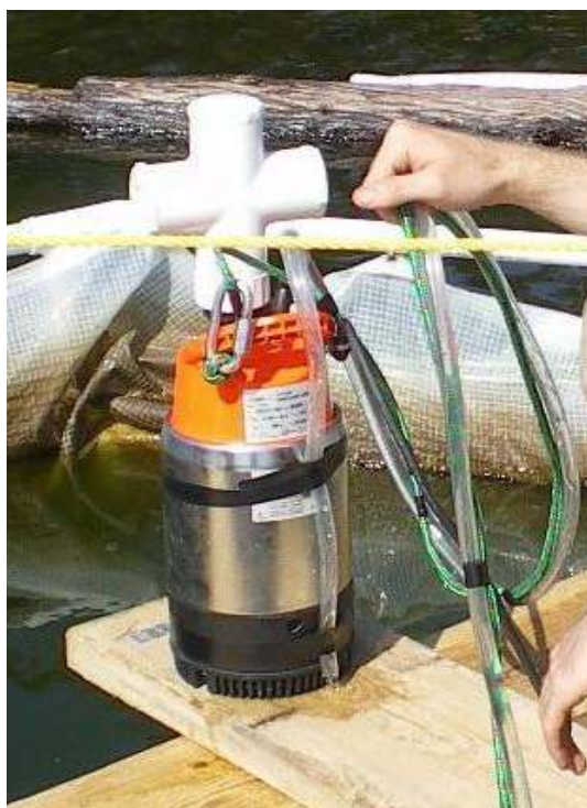
Figure 18: Pompe Flygt Ready 4 équipée de l'embout d'agitation rapide
