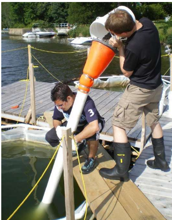
Figure 21: Tuyau verseur pour le dépôt du calcaire dans l'enclos AC
