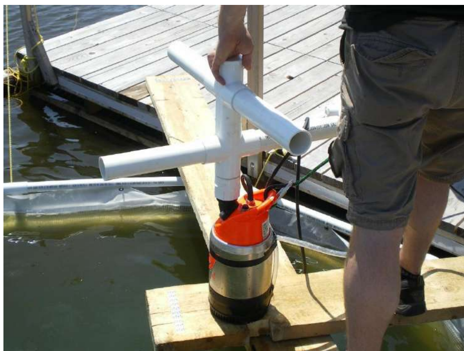
Figure 20: Pompe Flygt Ready 4 équipée de l'embout d'agitation lente
