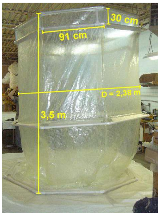
Figure 14: Enclos pleine hauteur tel que déployé
