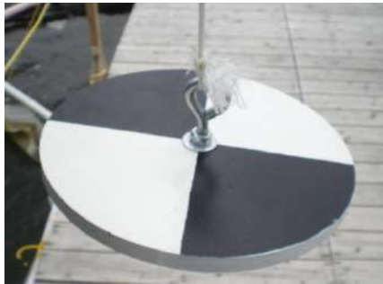
Figure 31: Disque Secchi utilisé pour les mesures de transparence de l'eau
