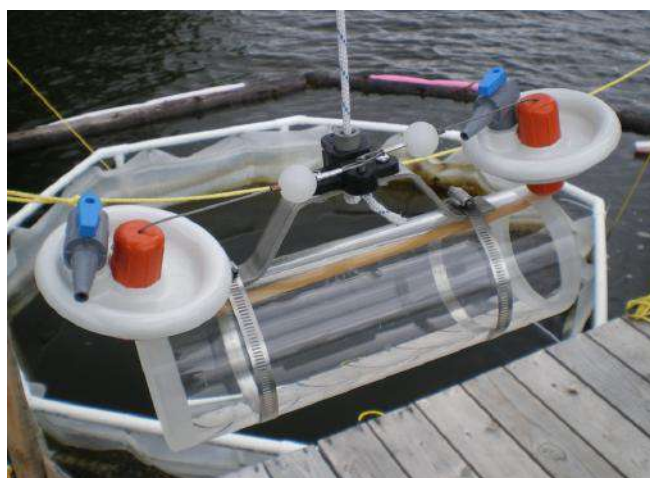
Figure 24: Bouteille de prélèvement en profondeur Van Dorn Beta de 2,2 L
