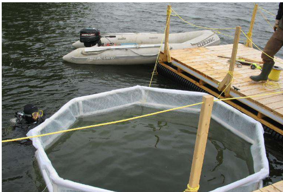
Figure 16 : Plongeur au travail pour fixer la toile dans les sédiments
