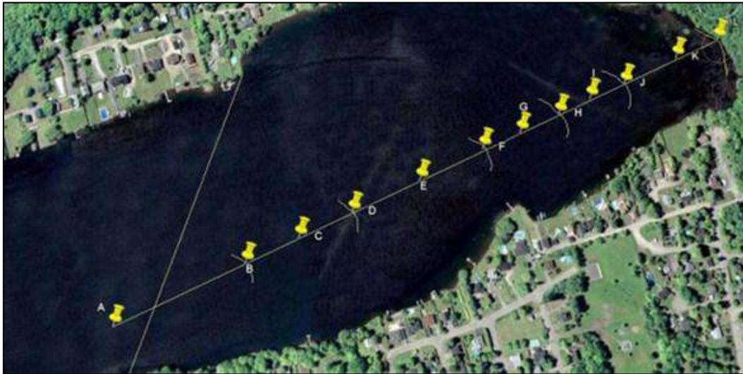
Figure 16 Lieux d'échantillonnage (A, C, F, I et K) pour les essais de diffusion du phosphore
