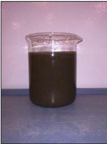
Figure 84 Surverse après hydrocyclonage des sédiments dragués hydrauliquement
