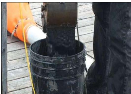
Figure 32 Déversement des sédiments dragués dans un seau
