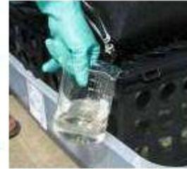
échantillons d'effluent par le coin du sac. Examiner la clarté de l'effluent. Ces échantillons peuvent également être utilisés pour fins d'analyse.
