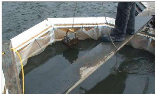
Figure 29 Benne Ekman utilisée pour le dragage mécanique
