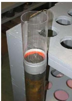
Figure 17 Montage de l'essai de diffusion du phosphore sur une carotte de sédiments
