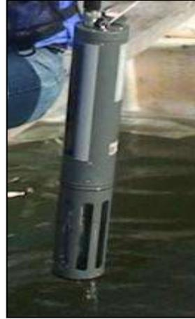
Figure 49 Sonde YSI 6600v2
