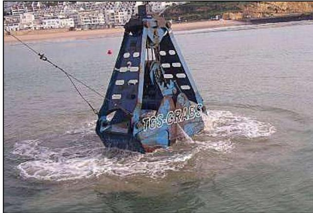
Figure 28 Dragage mécanique
