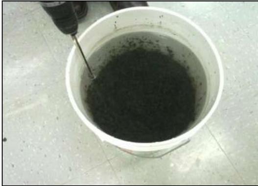
Figure 43 Brassage du mélange sédiments + polymère avec un mélangeur industriel
