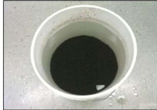
Figure 44 Floccs sédimentés après l'étape de coagulation par polymère
