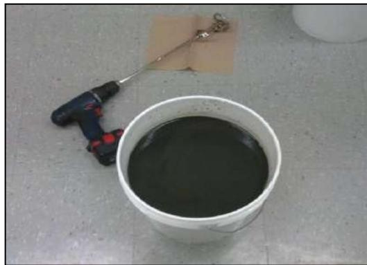
Figure 42 Sédiments issue du dragage hydraulique, après homogénéisation
