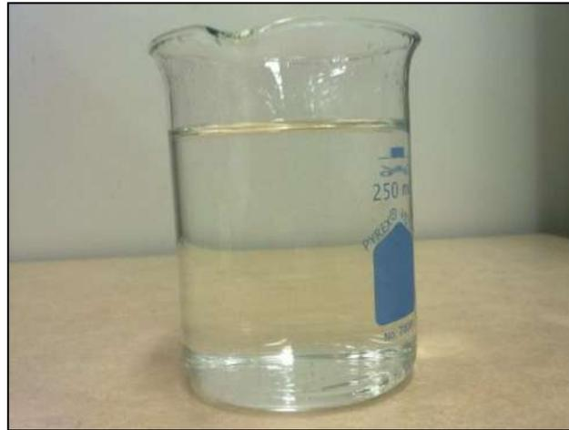
Figure 83 Phase liquide après coagulation avec polymère et filtration
