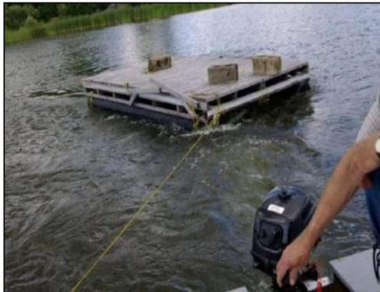
Figure 26 Transport d'un module de la plateforme jusqu'au site d'essais
