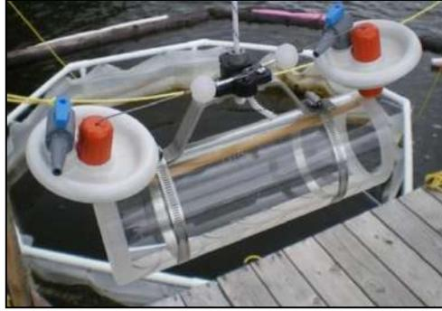
Figure 37 Bouteille de prélèvement en profondeur Van Dorn Beta de 2,2 L
