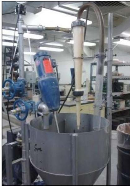
Figure 47 Hydrocyclone du département de génie des mines et de métallurgie
