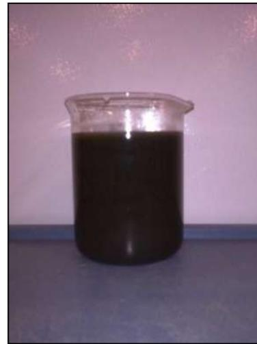
Figure 85 Sousverse après hydrocyclonage des sédiments dragués hydrauliquement
