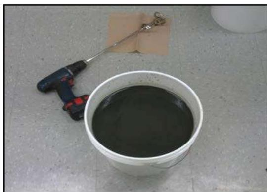
Sédiments dragage hydraulique
